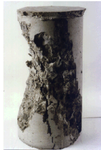
Abbildung 4: Petrographischer Dünnschliff(links) und Einaxialer Druckversuch (rechts) – Ingenieurgeologische Standardverfahren zur Bestimmung von Festgesteinseigenschaften
