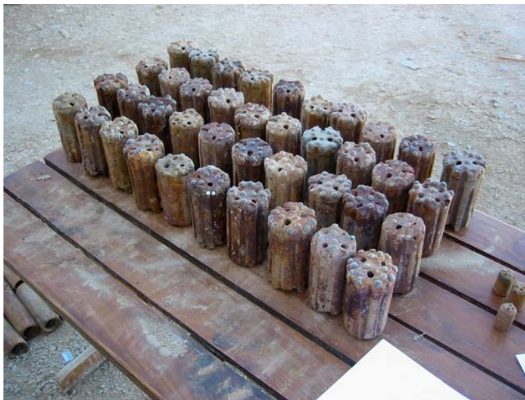
Abbildung 3: Auswertung der Bohrkronenverschleißform vor Ort (links) und Darstellung in Formblatt (rechts).
