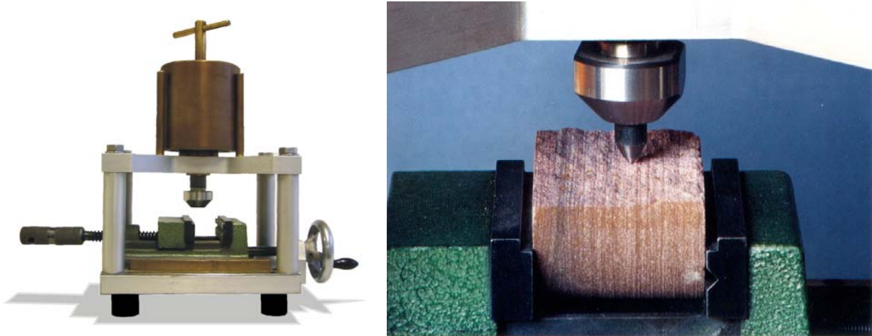
Abbildung 6: Cerchar-Abrasivitätsversuch: Typisches Prüfgerät (links) und auf Gesteinsprobe aufgesetzter Prüfstift vor dem Versuch (rechts).
