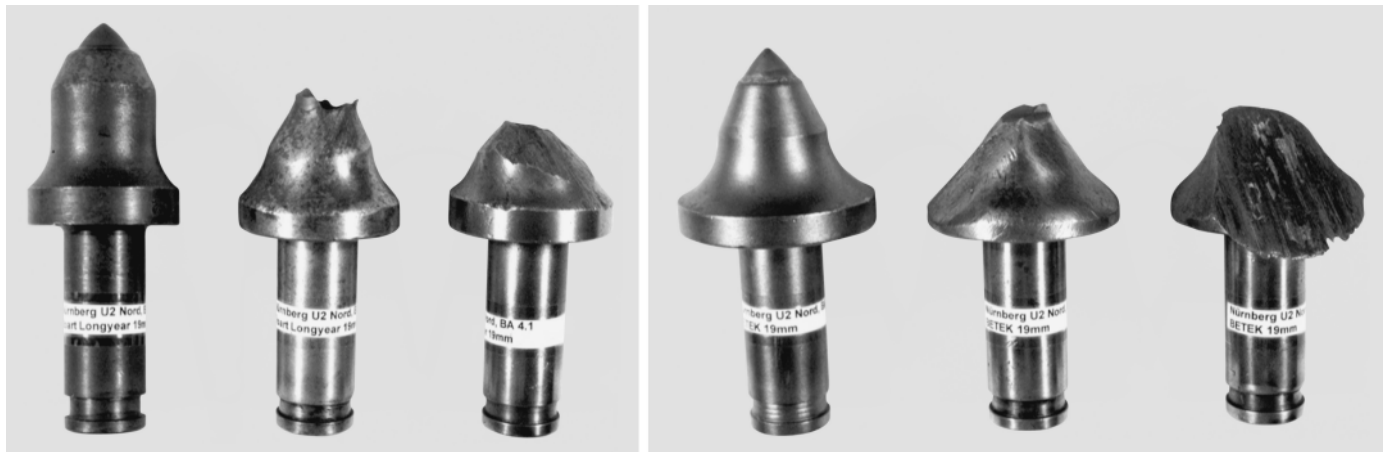
Bild 4 Gegenüberstellung fabrikneuer und verschlissener Rundschafftmeißel. Jeweils links: Fabrikneuer Meißel. Mitte: Aus- oder Sprödbbruch des Hartmetallstifts. Rechts: Einseitige Abnutzung infolge Sprödbrechts.
